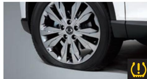
Система контроля давления воздуха в шинах
