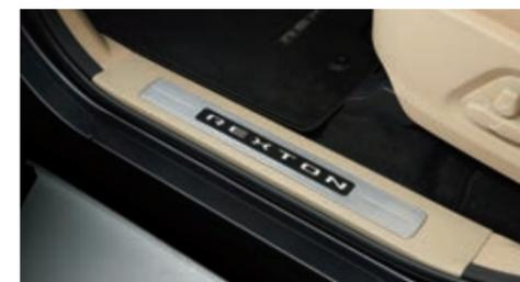
Накладки на внутренние части порогов дверей из нержавеющей стали с подсветкой
