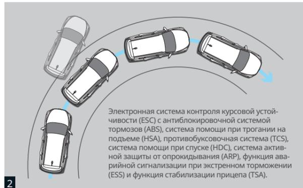
Электронная система контроля курсовой устойчивости (ESC) с антиблокировочной системой тормозов (ABS), система помощи при трогании на подъеме (HSA), противобуксовочная система (TCS), система помощи при спуске (HDC), система активной защиты от опрокидывания (ARP), функция аварийной сигнализации при экстренном торможении (ESS) и функция стабилизации прицепа (TSA).
